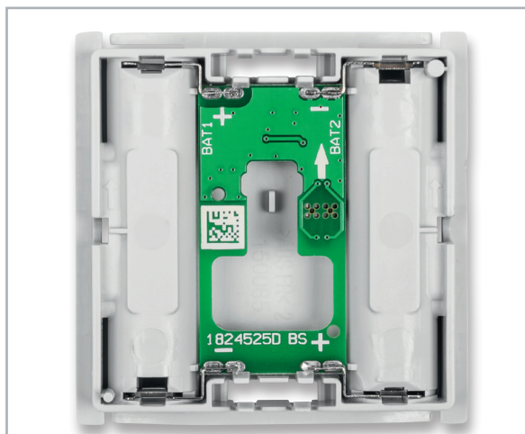
Bild 14: Die in das Gehäuse eingesetzte Batterieplatte
