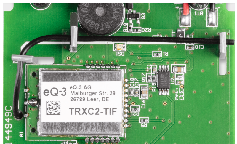
Bild 11: Die Verlegung der Antenne
