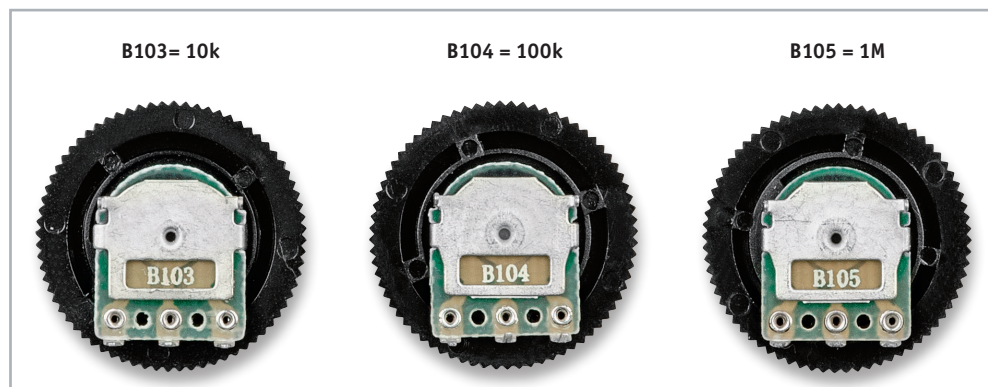
Bild 17: Die Widerstandswerte sind kodiert aufgedruckt.
