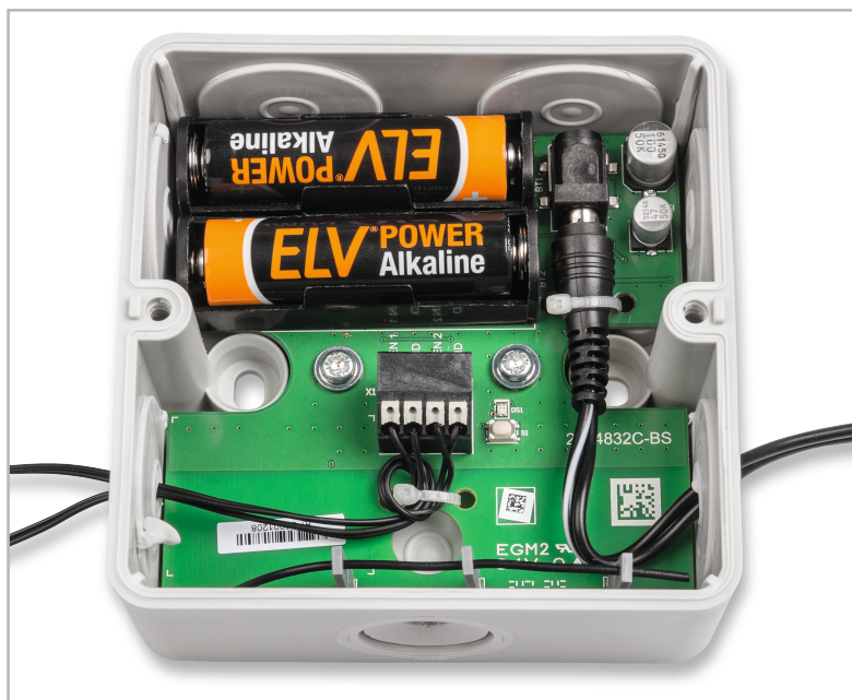
Bild 11: Fertig montierter 2-fach-Temperatursensor in der als Zubehör erhältlichen Abox 040
