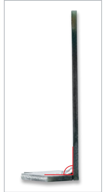
Bild 10: Senkrechte Ausrichtung der Platinen
