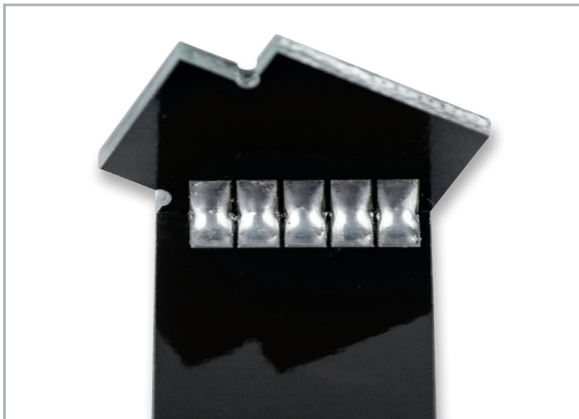
Bild 11: Innenseite der verlötete Abdeckkappe
