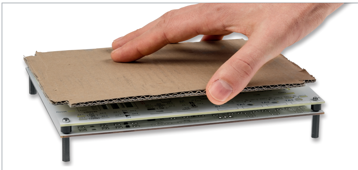
Bild 48: Ein Stück Pappe verhindert, dass die zuvor bestückten Bauteile beim Umdrehen der Platine herausfallen. Die Ecken müssen, wie abgebildet, noch zugeschnitten werden.
