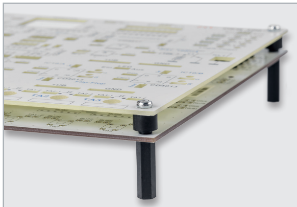
Bild 45: So werden Frontplatte und Platine mittels Abstandshalter verschraubt.
