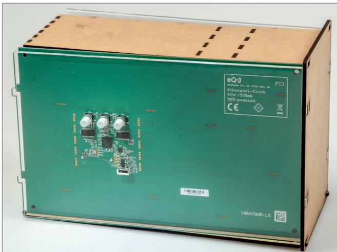
Die Frontplatte wird genauso wie die Rückplatte montiert. Dabei darf die Leuchtkastenfolie, die der Lichtverteilung dient, nicht vergessen werden.
