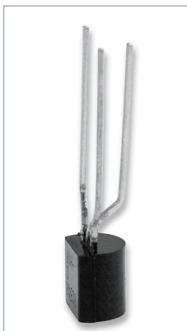
Bild 10: Der mittlere Anschluss des Transistors ist wie hier gezeigt in Richtung runde Gehäusesseite abzuwinkeln.
