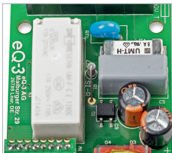
Bild 4: So ist der Sicherungswiderstand R1 zu montieren.
