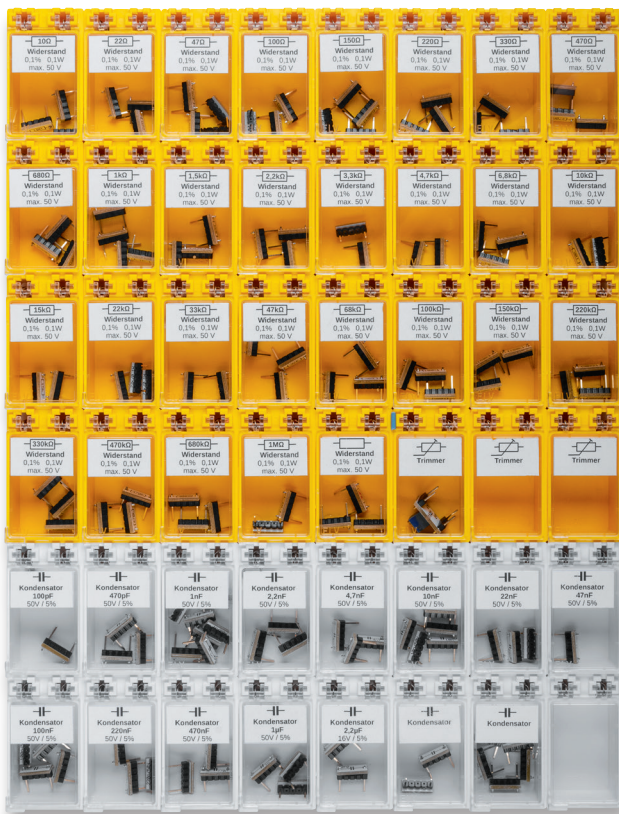
Bild 12: SMD-Boxen in mittlerer Größen eignen sich hervorragend zur Archivierung der einzelnen Module vom PAD3. Die durchsichtigen Deckel sind mit Typenschildern gekennzeichnet (rechts). Auf der linken Seite sind die Module auf festen Schaumstoff aufgesteckt.
