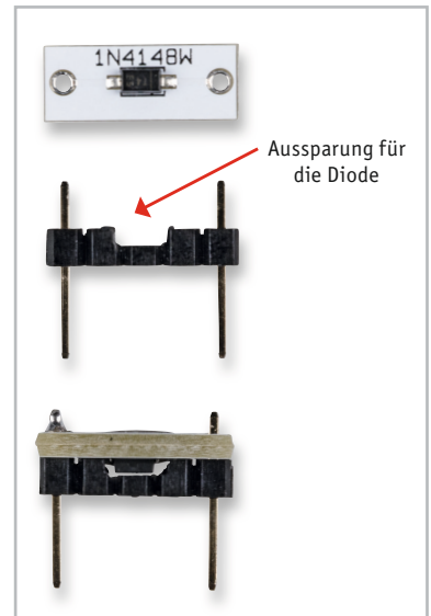
Bild 24: Für die Dioden muss der Körper der Stiftleisten bearbeitet werden.
