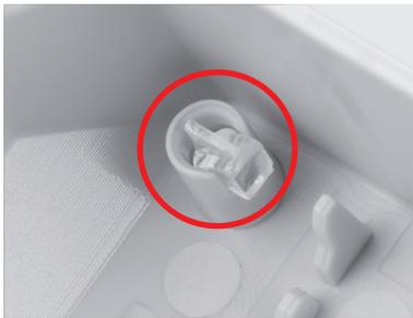
Bild 14: Der in das Gehäuseoberteil eingesetzte Lichtleiter
