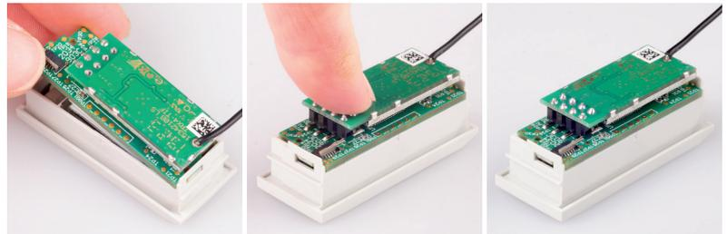
... bevor die Displayplatine dann richtig herum ausgerichtet sanft in die Fronthalterung eingerastet wird.
