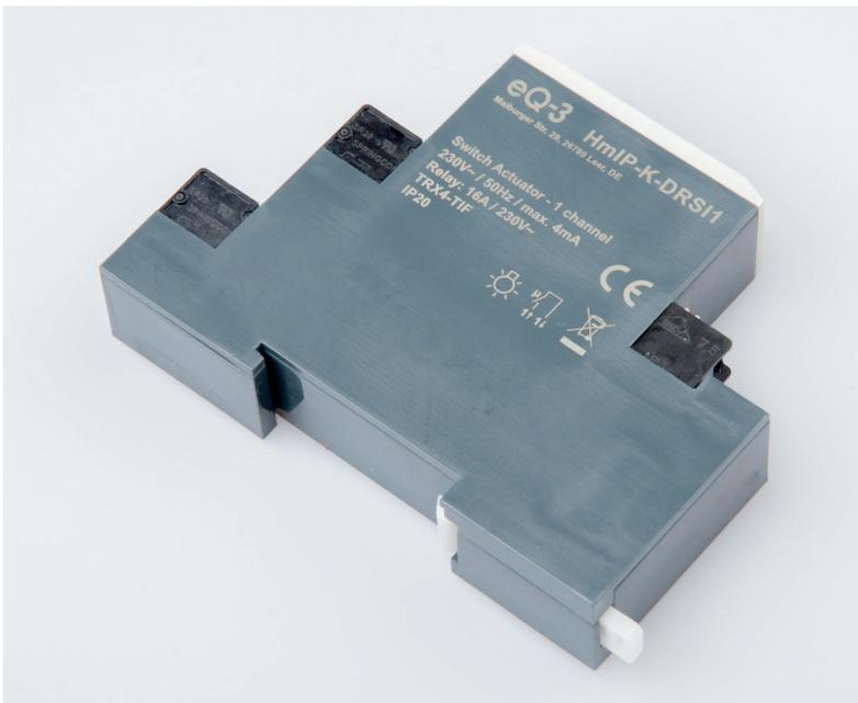
Nach der Prüfung wird das Gehäuse durch Einrasten des Gehäusedeckels fest verschlossen.
