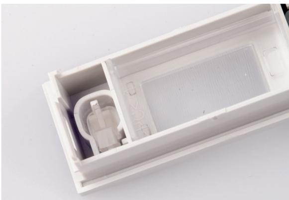
Danach werden nun die 3 Tastelemente in die zugehörigen Führungen in der Front eingesetzt.
