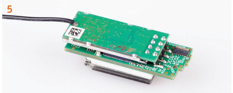
Jetzt muss lediglich noch das Funkmodul bestückt werden. Dieses wird so montiert, dass die Antenne von der Platine weg zeigt.
