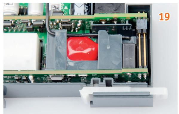
Zum Abschluss wird noch der Rastschieber in den unteren Gehäusebereich eingelegt.
