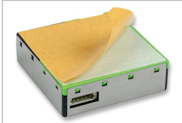
Bild 30: Anbringen einer doppelseitigen Schaumstoff-Klebefolie am Sensor
