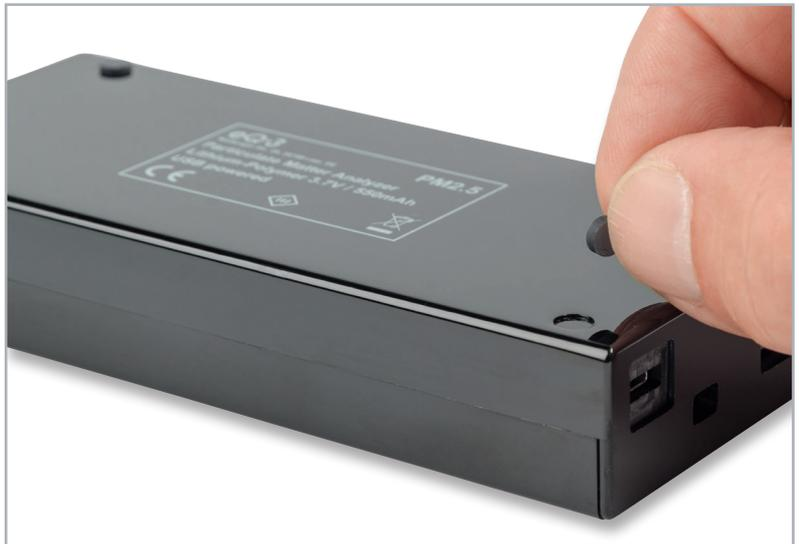
Bild 38: Ankleben der 4 Gehäusefüße an der Gehäuseunterseite
