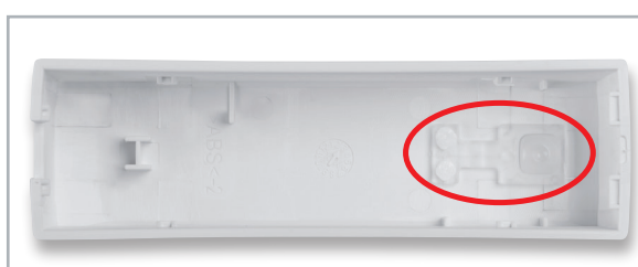
Bild 10: Der Lichtleiter, der gleichzeitig als Tasterstößel dient, ist bereits ab Werk montiert.
