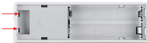
Bild 12: So erfolgt das Einlegen der Einheit Platine/ Gehäuseunterteil in das Gehäuseoberteil. Sie muss auf der links liegenden Seite einrasten, siehe Pfeilmarkierungen.
