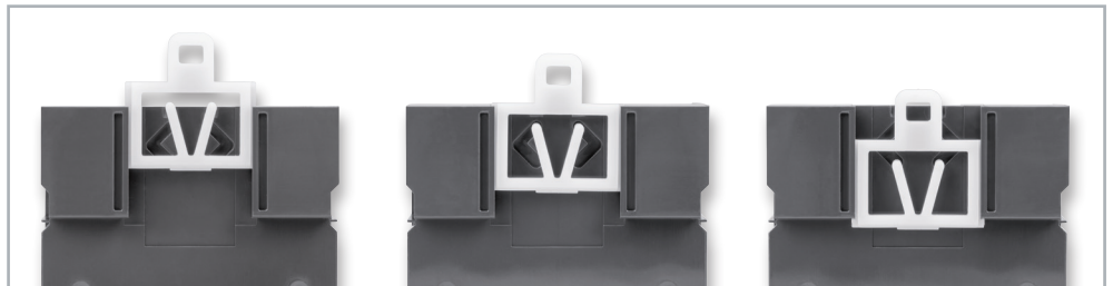
Bild 24: Das Einsetzen des Rasthebels erfolgt in drei Schritten: in die Führung einsetzen (links), bis zur ersten Rastung schieben (Mitte) und schließlich bis zur zweiten Rastung in die Endposition schieben (rechts).
