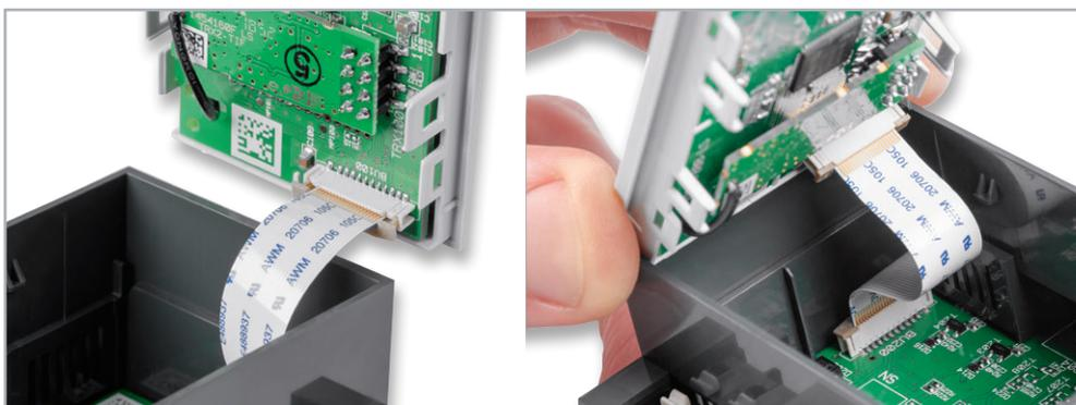
Bild 29: Das FFC-Kabel ist, wie hier gezeigt, mit der Displayplatine zu verbinden. Auch hier ist wieder auf die Lage der Kontaktflächen zu achten (siehe Text). Beim Aufsetzen des Gehäuseoberteils auf das Mittelteil muss das FFC-Kabel vorsichtig zu einer Schlaufe gebogen werden.
