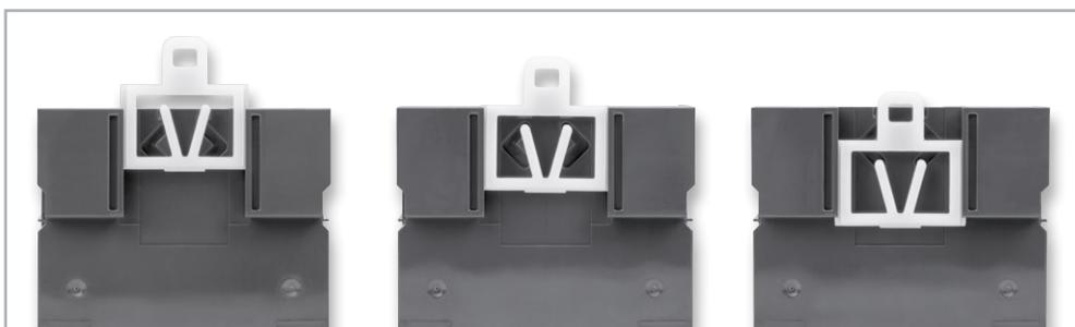
Bild 24: Das Einsetzen des Rasthebels erfolgt in drei Schritten: in die Führung einsetzen (links), bis zur ersten Rastung schieben (Mitte), und schließlich bis zur zweiten Rastung in die Endposition schieben (rechts).
