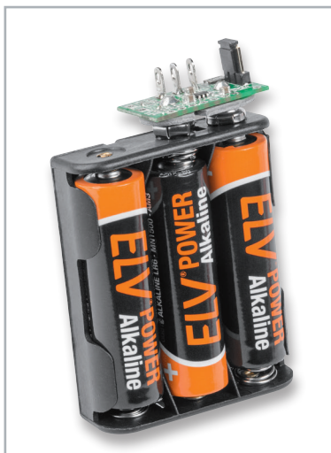
Bild 6: Platine mit eingelöteter 3-poligen Stiftleiste und Lötstiften mit Öse an der Platinenoberseite
