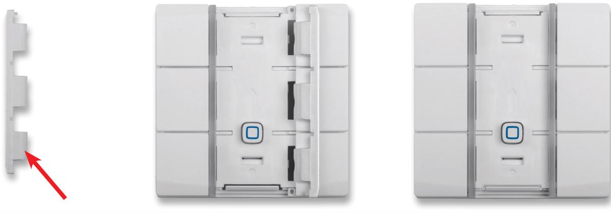
Schritt 5: Die Lichtleiter werden in die Schlitz neben den Tasten eingesetzt. Die Lichtleiter besitzen auf einer Seite Einkerbungen, die zur Gehäusemitte hin eingesetzt werden und hierdurch mit der Tasterkappe verrasten.
