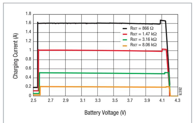
Bild 5: Ladeströme in Abhängigkeit von der Zellenspannung
