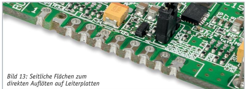
Bild 13: Seitliche Flächen zum direkten Auflöten auf Leiterplatten
