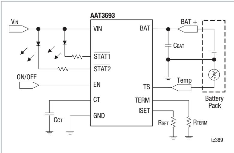
Bild 1: Typische Beschaltung des Ladecontrollers AAT3693
