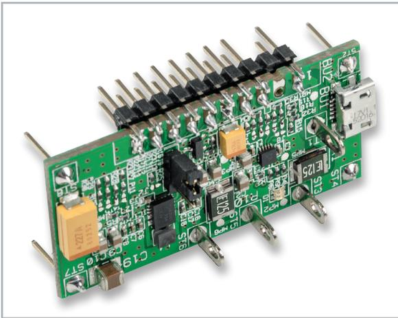
Bild 11: Alternative Bestückung mit einer geraden zweireihigen Stiftleiste
