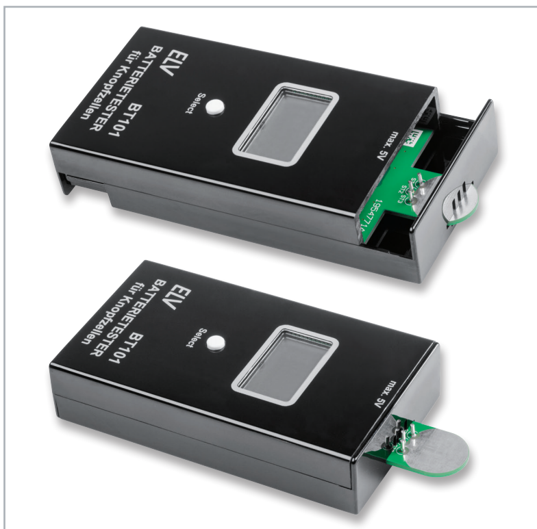
Bild 20: ... werden die Gehäusenhälften bis zum Anschlag zusammengeschoben.
