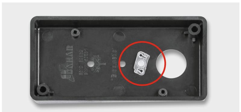
Bild 12: Hier ist der in die Gehäuseoberseite eingelegte Lichtleiter in seiner exakten Position zu sehen. Er ist nach probeweisem Einlegen der Platine mit einem Tropfen Sekundenkleber zu verkleben.
