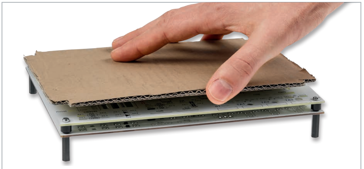
Bild 5: Ein Stück Pappe verhindert, dass die zuvor bestückten Bauteile beim Umdrehen der Platine herausfallen. Die Ecken müssen, wie abgebildet, noch zugeschnitten werden.
