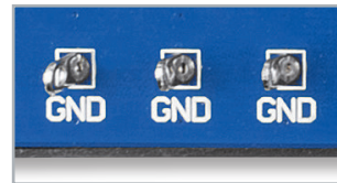
Bild 10: Massepunkte (Lötlösen) erlauben den bequemen Anschluss von Messgeräten (GND-Anschluss)
