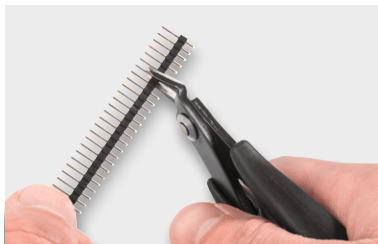
Bild 19: So werden die Stiftleisten zugeschnitten.
