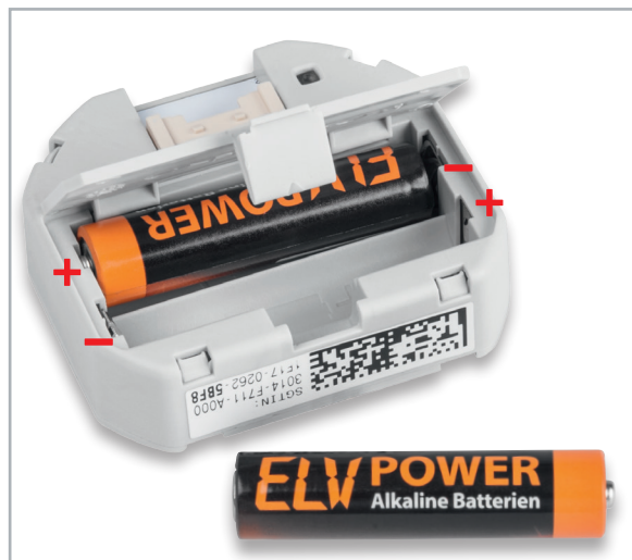
Bild 13: So erfolgt das polrichtige Einlegen der Batterien.
