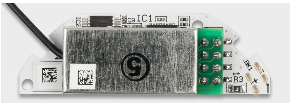
Bild 4: Das bestückte und verlötete Funkmodul von oben gesehen
