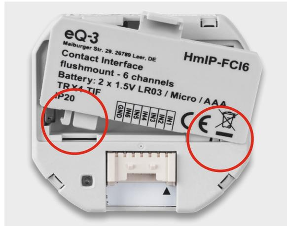
Bild 10: Beim Einklinken des Batteriefachdeckels sind die beiden Scharnierzapfen vorsichtig einzurasten.
