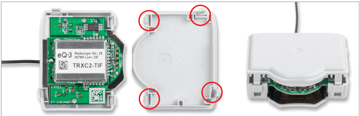
Bild 8: Das Zusammenfügen des Gehäuses erfolgt durch Aufsetzen der Gehäuseunterschale und Verrasten (rechts) der vier Gehäuse- und Verrastungen.
