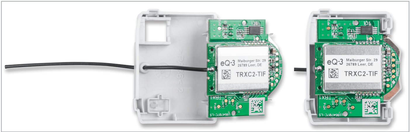
Bild 7: So erfolgen das Durchfädeln der Antenne durch die Gehäuseober- und -unterschale und das Einlegen der Platine in das Gehäuse (rechts).
