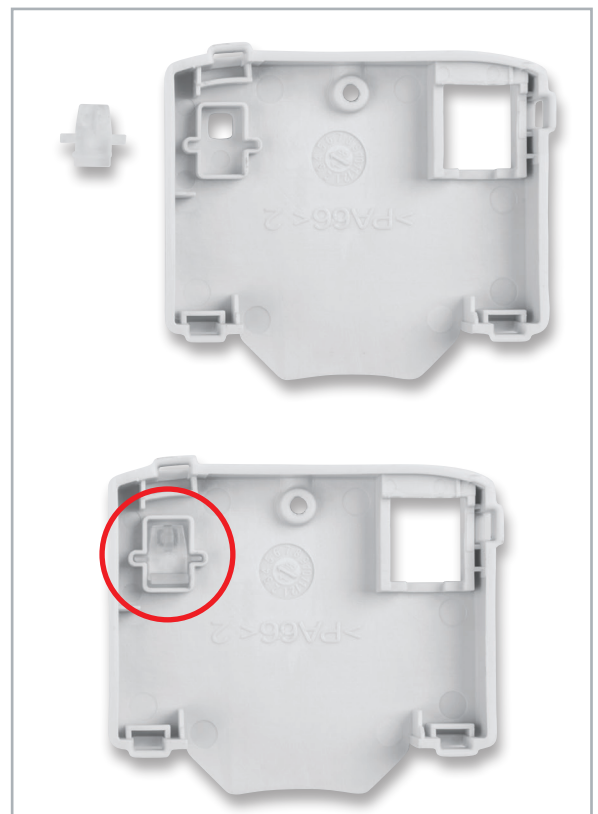
Bild 6: Der Lichtleiter für die Geräte-LED wird wie hier gezeigt in die Gehäuseoberseite eingeleitet.
