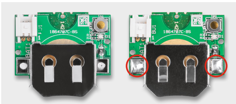
Bild 4: Hier ist die Montage des Buchsensteckers BU1 und des Batteriehalters zu sehen. Der Batteriehalter ist mit reichlich Lötzinn anzulöten, da er durch die Batterie mechanisch belastet wird.
