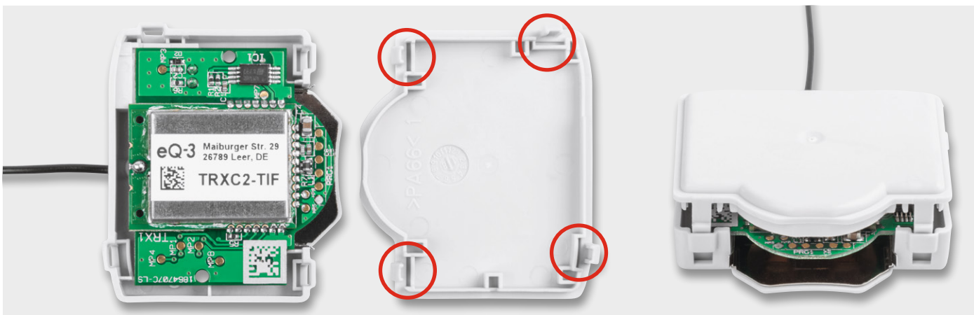
Bild 8: Das Zusammenfügen des Gehäuses erfolgt durch Aufsetzen der Gehäuseunterschale und Verrasten (rechts) der vier Gehäuserasten.
