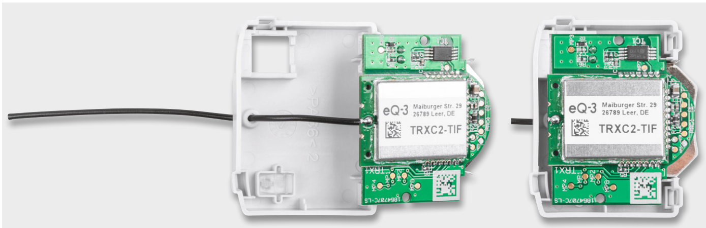
Bild 7: So erfolgen das Durchfädeln der Antenne durch die Gehäuseoberseite und das Einlegen der Platine in das Gehäuse (rechts).
