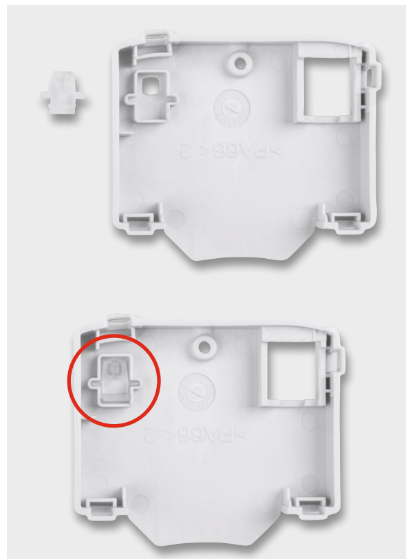
Bild 6: Der Lichtleiter für die Geräte-LED wird wie hier gezeigt in die Gehäuseoberseite eingelegt.
