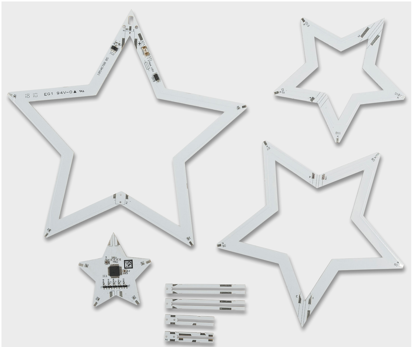
Bild 4: Die fertig vorbereiteten Platinen des Bausatzes
