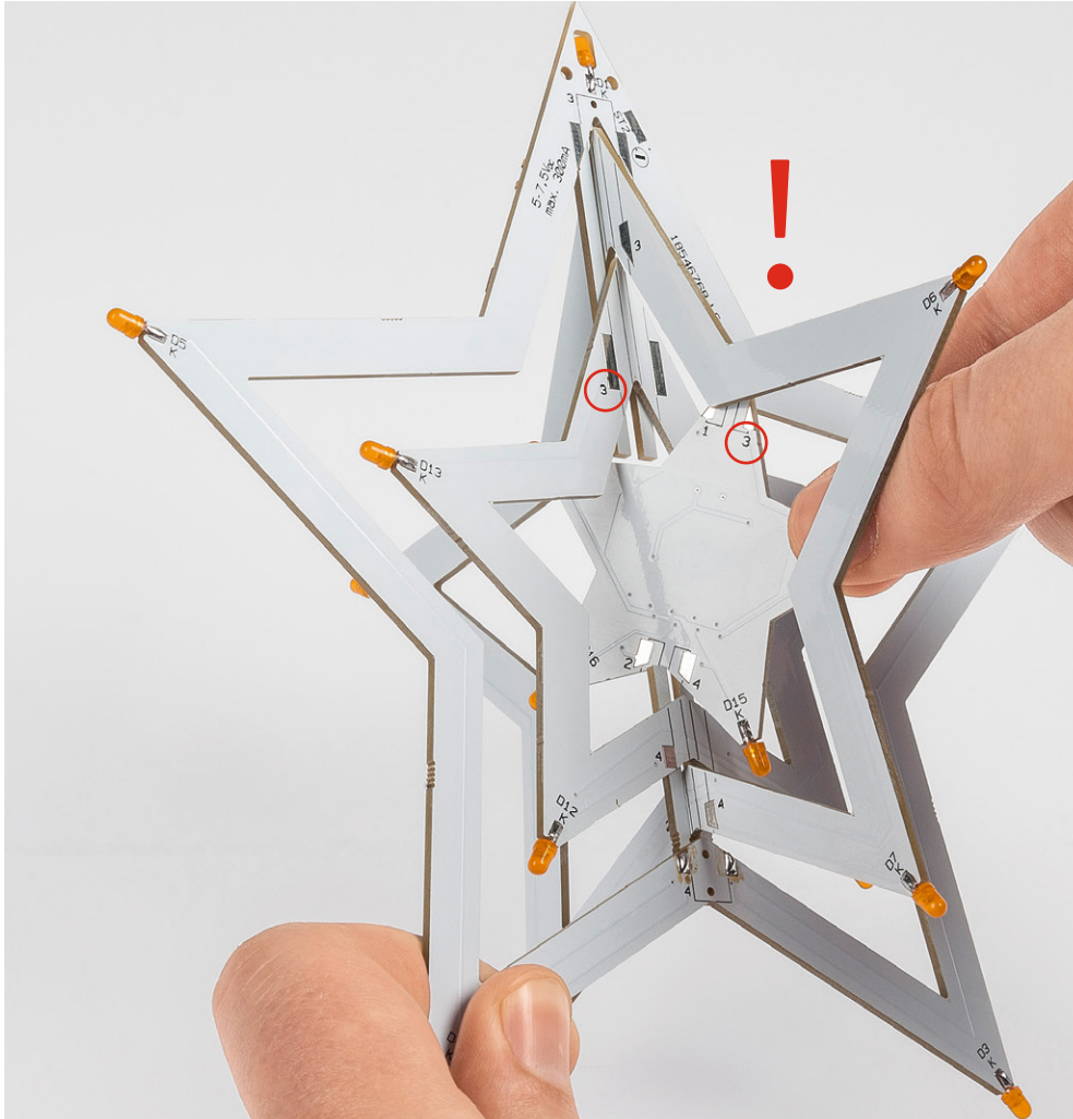
Bild 11: Die mittlere Sternplatine wird eingesetzt.
