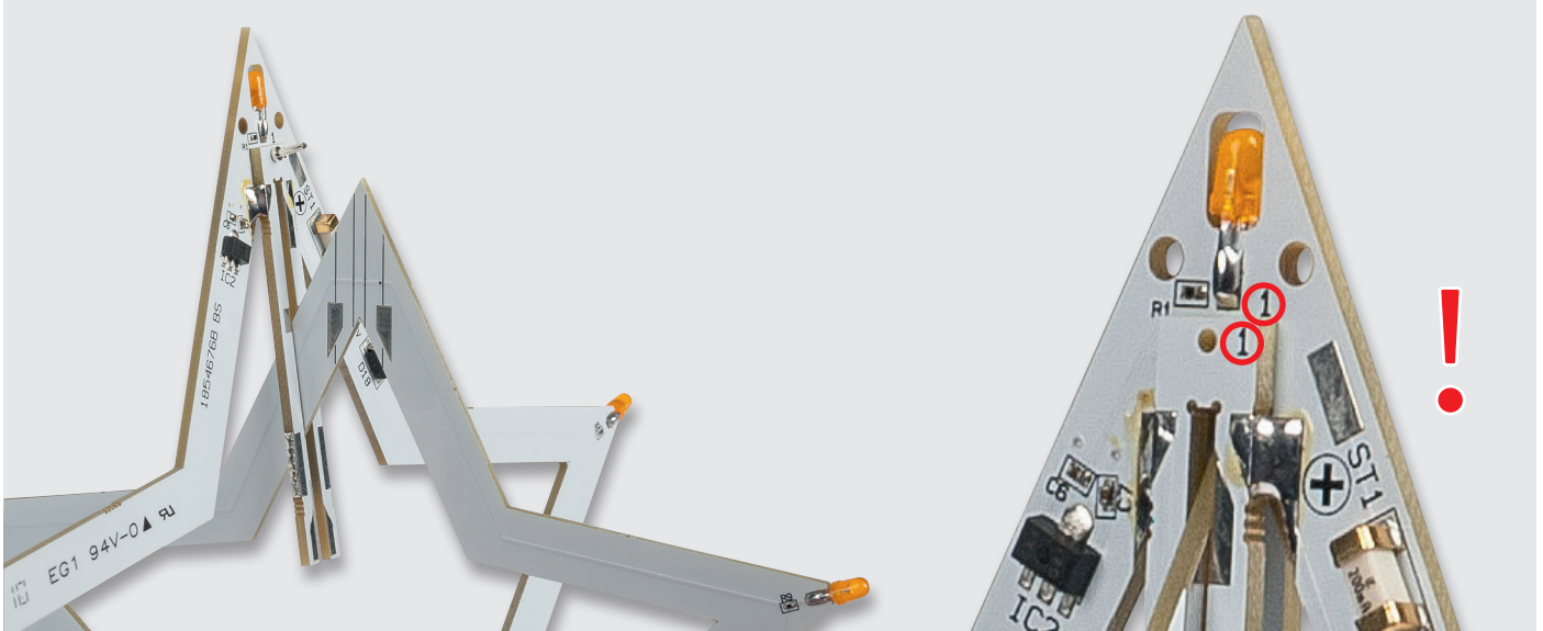
Bild 9: So wird die Stegplatine Nr. 1 eingesetzt und verlötet.
