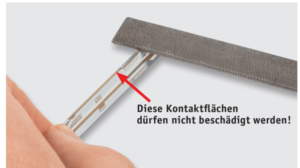
Bild 3: Der Grat wird vorsichtig mit einer Feile entfernt, ohne die Kontakte zu beschädigen.
