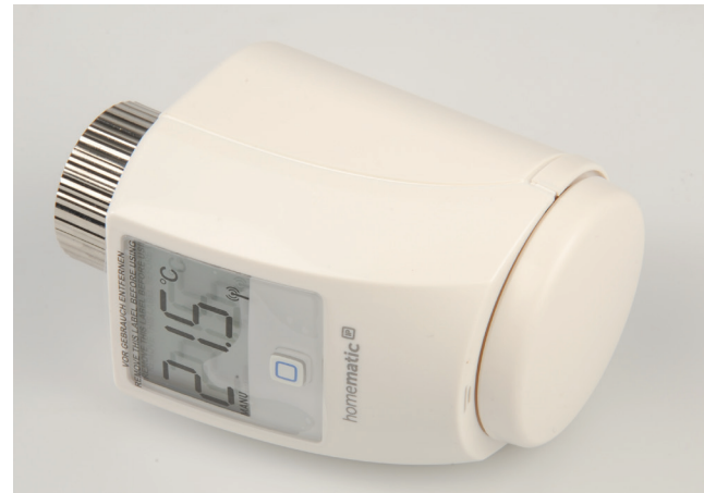
Bild 21: Das fertige Gerät mit aufgesetztem Handdrehrad und Batteriefachdeckel
