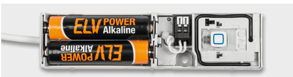
Bild 12: Hier sind die ordnungsgemäß in das betriebsfertige Gerät eingelegten Batterien zu sehen.
