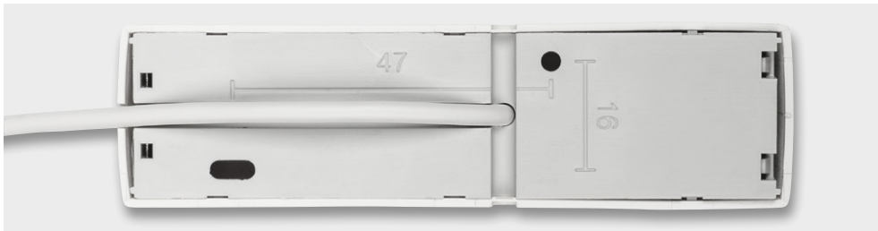
Bild 9: Das Verbindungskabel zum Kontakt wird, wie hier gezeigt, durch einen der Kabelkanäle auf der Geräte Rückseite und die zugehörige Bohrung in das Gehäuse geführt. Hier ist auch das entsprechend vorbereitete Gehäuseoberteil aufgesetzt.
