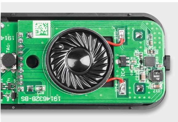
Bild 9: So wird der Lautsprecher angeschlossen und in die Batterieplatte eingesetzt.
