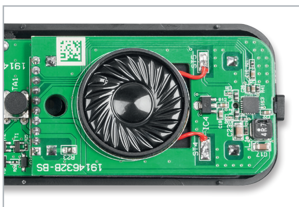
Bild 9: So wird der Lautsprecher angeschlossen und in die Batterieplatte eingesetzt.
