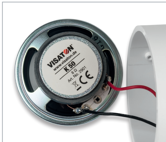
Bild 14: Anlöten der Lautsprecherleitungen unter Beachtung der korrekten Polarität
