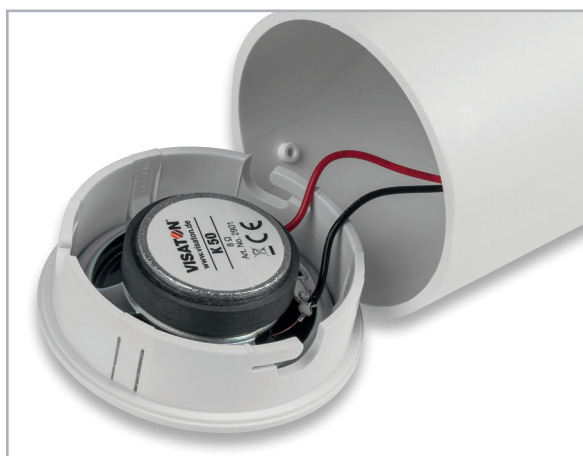
Bild 17: Einrasten des Lautsprechers im Deckel
