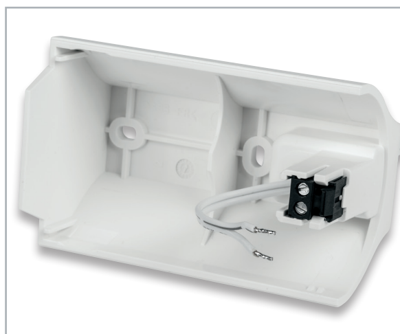
Bild 20: Fertig vorbereitete Leitungsenden des Steckernetzteils
