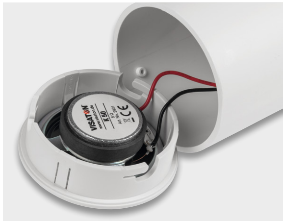
Bild 17: Einrasten des Lautsprechers im Deckel
