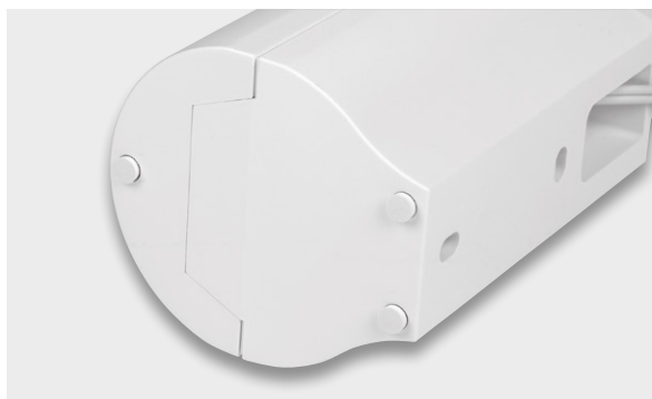
Bild 22: Ankleben der Gehäusefüße
