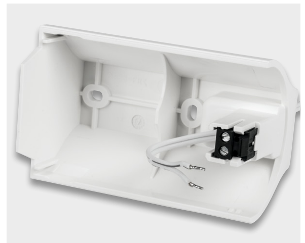
Bild 20: Fertig vorbereitete Leitungsenden des Steckernetzteils
