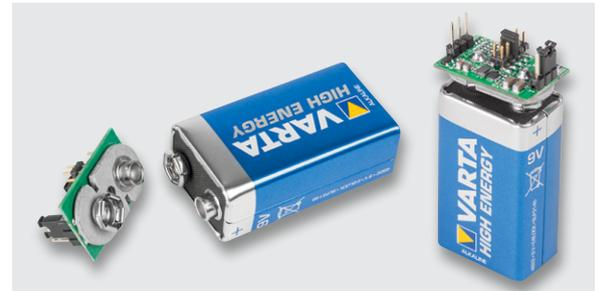
Bild 1: BAP5 aufgesteckt auf einer 9-V-Blockbatterie
