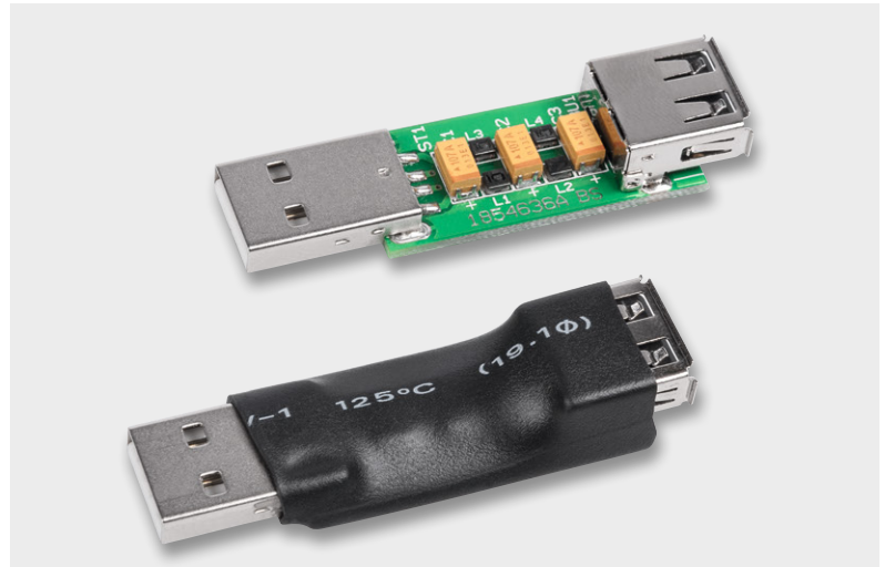
Bild 4: Das USB-EF1 vor und nach dem Einschrumpfen
