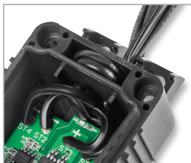
Bild 15: Die Anschlussleitungen sind so auszu- richten, dass der Lichtleiter des Deckels über der LED positioniert werden kann.
