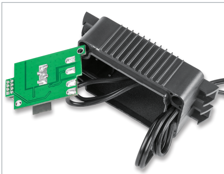
Bild 13: Verlöten der Anschlussleitungen an der Platinenunterseite
