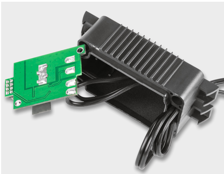
Bild 13: Verlöten der Anschlussleitungen an der Platinenunterseite
