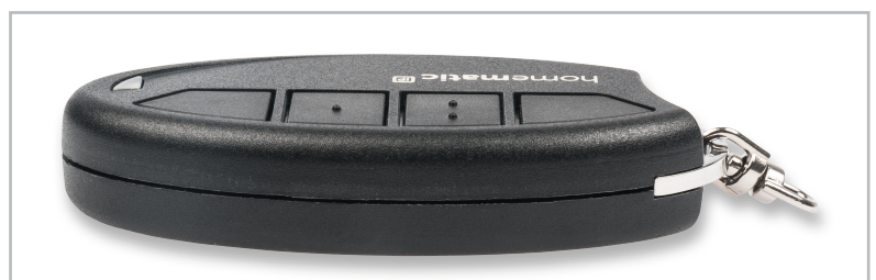
Bild 18: Zum Abschluss erfolgt eine Rundum-Kontrolle auf ein gleichmäßiges Spaltmaß zwischen den Gehäuseshalen.
