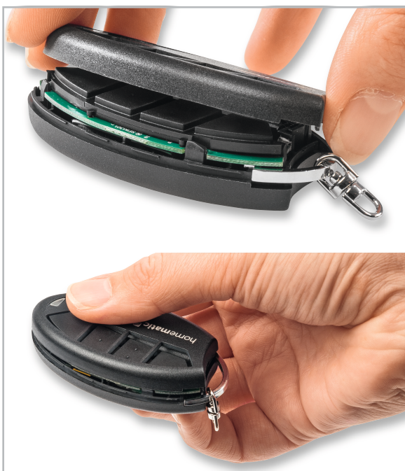
Bild 16: Zum Zusammensetzen der Gehäusenhälften ist zunächst die Gehäuseoberschale von der Batterieseite her seitlich einzusetzen (oben), danach drückt man beide Gehäuseshalen bis zum Einrasten zusammen.
