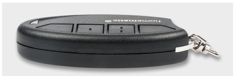
Bild 18: Zum Abschluss erfolgt eine Rundum-Kontrolle auf ein gleichmäßiges Spaltmaß zwischen den Gehäuseshälften.
