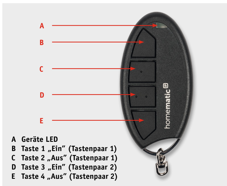
Bild 3: Die vier Bedientasten bilden zwei Tastenpaare, sind aber auch einzeln nutzbar.
