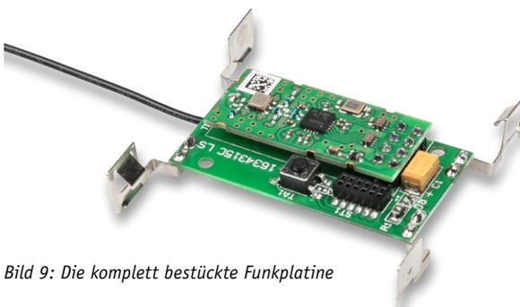
Bild 9: Die komplett bestückte Funkplatine
