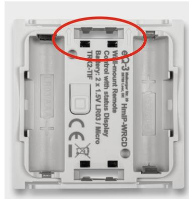
Bild 20: Beim Aufsetzen des Anzeigeräts ist ebenfalls darauf zu achten, dass die eingepprägten Pfeile nach oben weisen.
