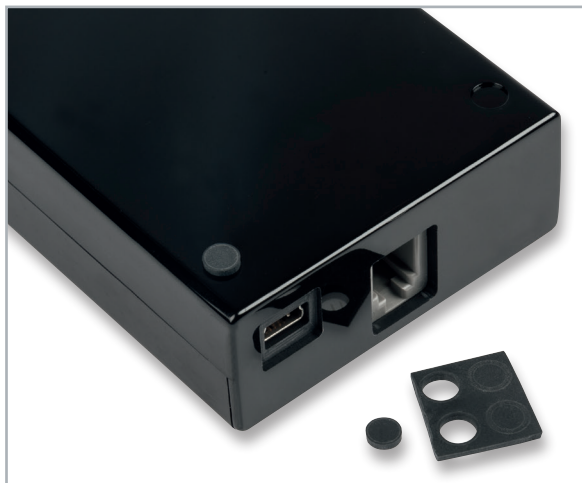
Bild 29: Ankleben der 4 Gehäusefüße an der Gehäuseunterseite
