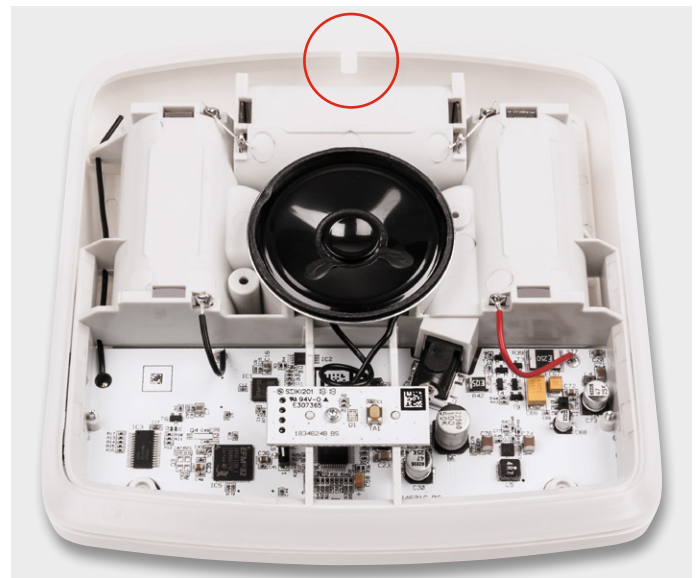
Bild 17: So wird der Leuchtrahmen aufgelegt. Die Nase des Rahmens muss oben liegen.
