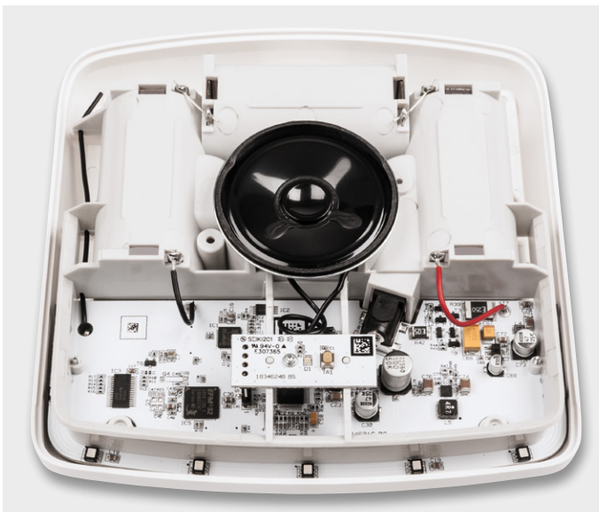
Bild 16: Die Platinenmontage wird mit dem Aufstecken der Tasterplatte komplettiert.
