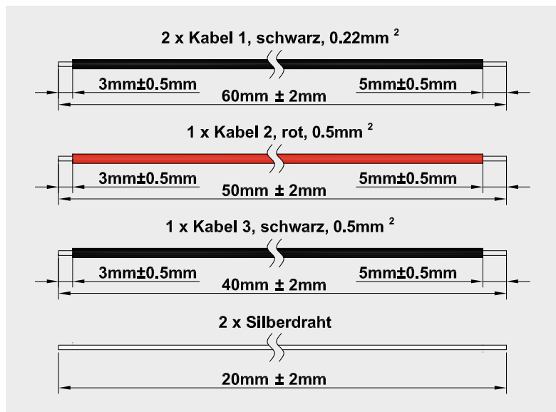
Bild 9: So sind die Kabel für die Verdrahtung des Gerätes vorzubereiten.
