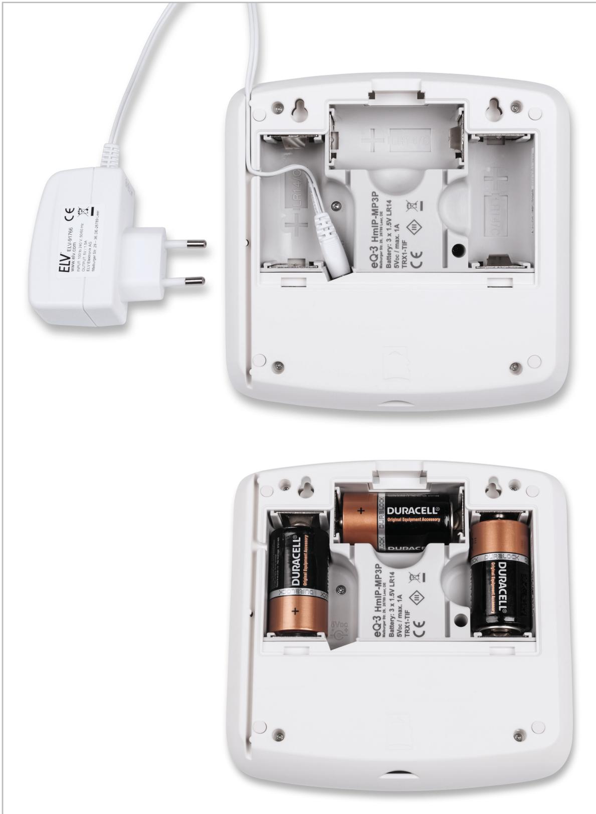
Bild 20: Hier sind die Lage des Steckers und der Zuleitung des Netzteils sowie ein richtig eingelegter Batteriesatz zu sehen.
