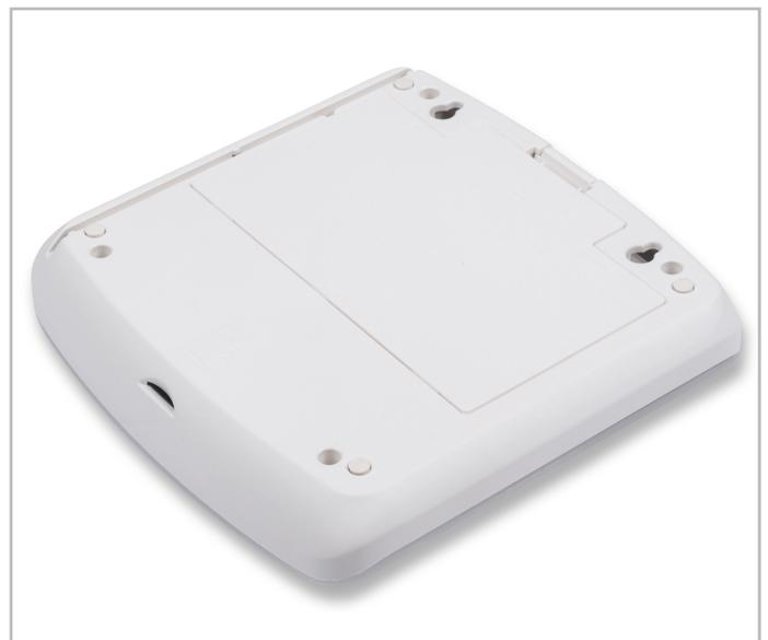
Bild 19: Mit dem Aufkleben der Gehäusefüße und dem Einsetzen des Batterie-fachdeckels ist die Montage komplett.
