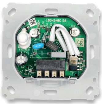
Bild 11: Die Leistungsplatine wird mit der Buchsenleiste in die Stiftleiste der Controllerplatine eingesetzt ...
