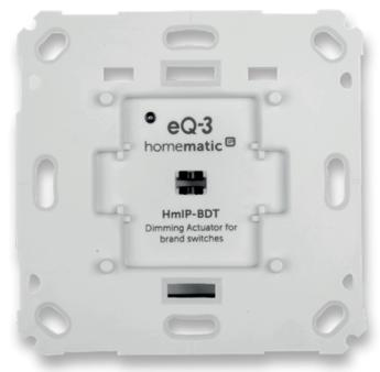
Bild 13: Nach dem Zusammenbau des Gehäuses ist mit einem spitzen Gegenstand die Beweglichkeit des Tasterstößels zu testen.
