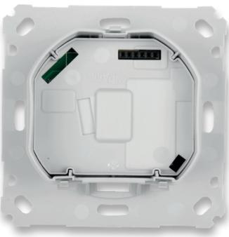
Bild 10: Vor dem Einlegen der Leistungsplatine ist die Isolierplatte einzulegen, und zwar so, dass der Ausschnitt für die Stiftleiste mit dieser korrespondiert.
