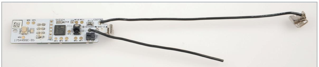
gen Masse gezogen. In Abhängigkeit der einfallenden Lichtstärke ändert sich die Spannung über R8 und damit am Messeingang des Controllers.
