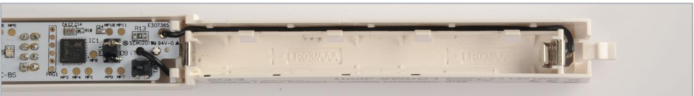
Bild 8: Die Batterieleitung ist schließlich unter die Rastnasen des Gehäuses zu drücken, sodass sie fest fixiert ist.
