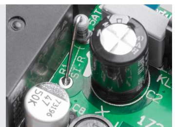
Bild 8: So ist der Sicherungswiderstand R1 einzubauen.
